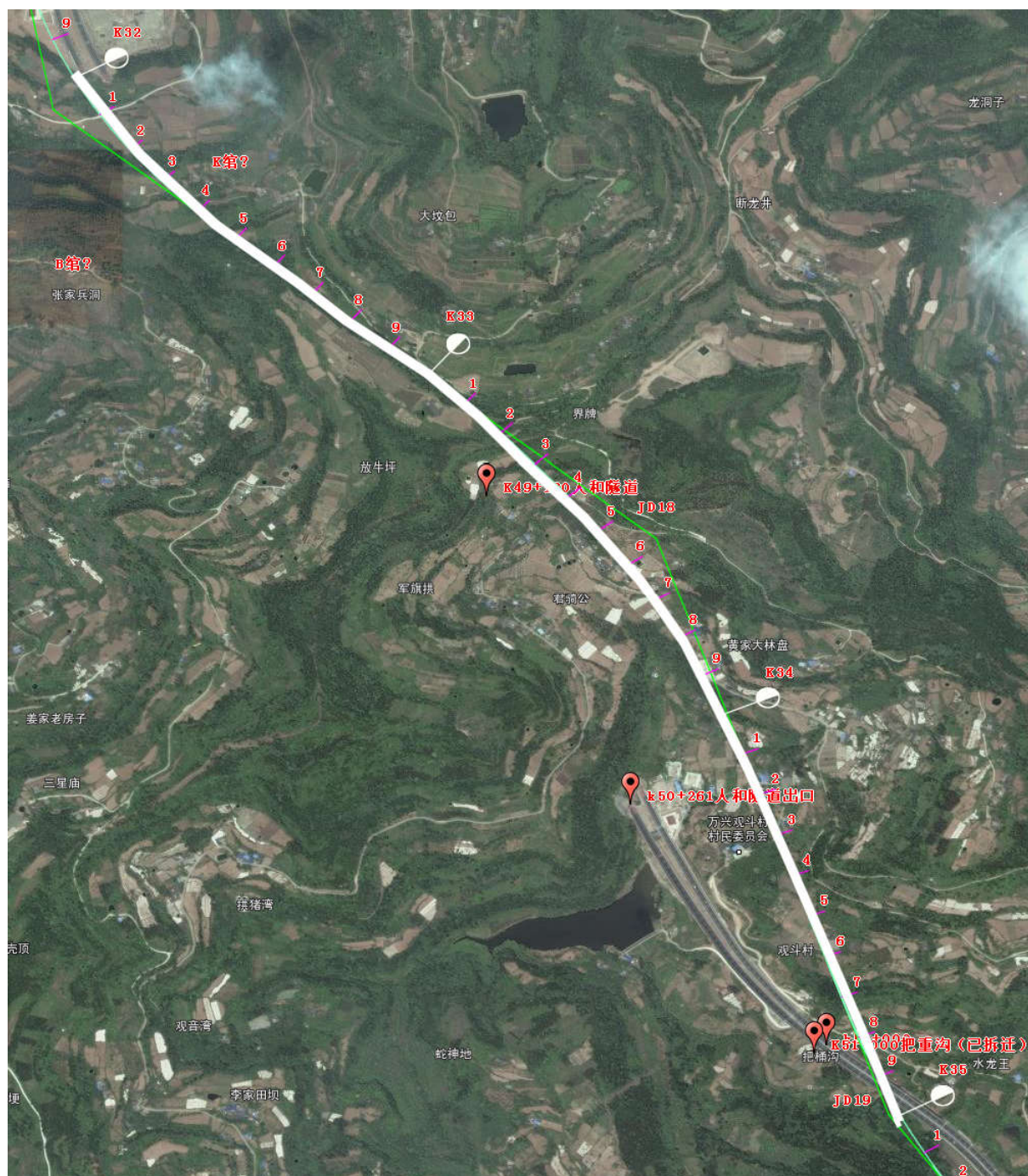
图 2-2.4 K48+000~K51+500 人和隧道段线路偏移工可与实际对比图
