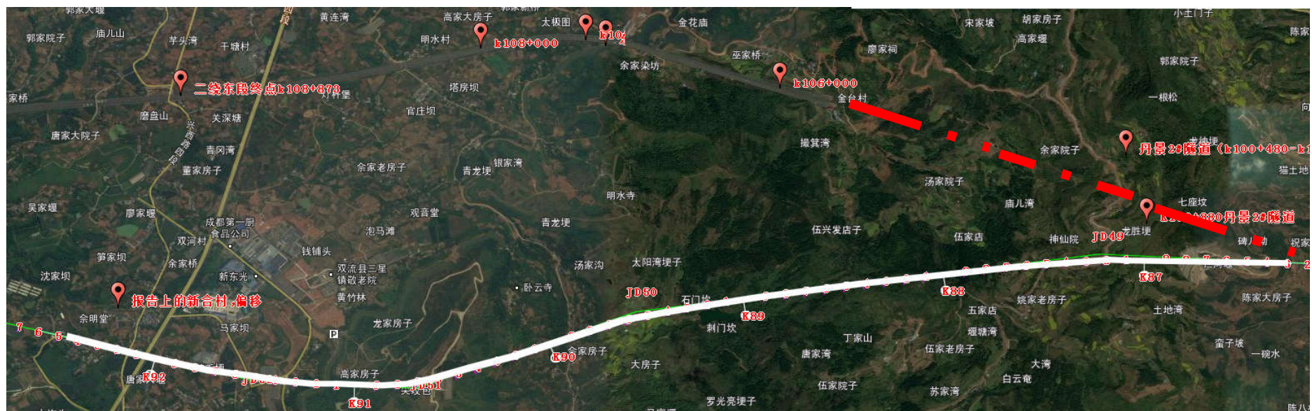
图 2-2.12 K103+200~K108+894 丹景至终点段线路偏移工可与实际对比图
